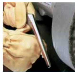
Шлифлента 3M™ 307EA A100 Титановые имплантанты Обработано 12 деталей вместо 4 обычными абразивами. Меньшее тепловыделение.
